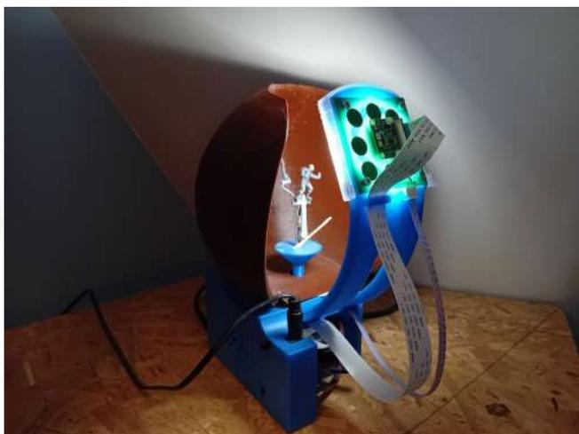
La méthode de lumière structurée est plus précise et intéressante car c'est un projecteur qui ajoute une grille fixe sur la figurine scannée et c'est grâce à cette grille que les points sont comparés dans le logiciel.
