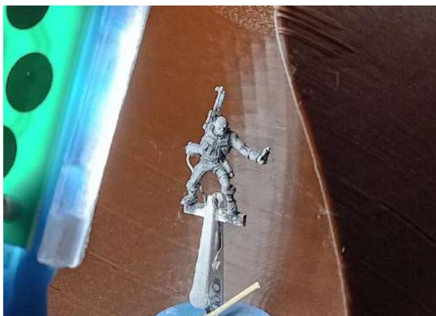
*Trashfire : Mon installation OpenScan allumée et une figurine en cours de scan préparée avec une sous-couche noire et le spray matifiant*
