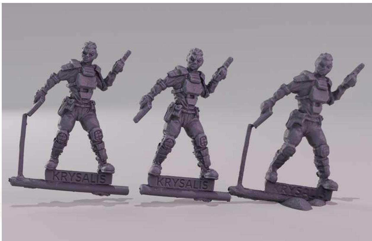
*Scan d'une figurine de Krysalis avec plusieurs scanners différents, de gauche à droite : Zealot avec le scan Mechscan <https://www.mechscan.co.uk/>, scan de Ghan Factory, et OpenScan avec un traitement rapide*
